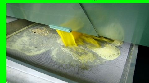
Filtration der Altlasten auf Edelstahlgitter
