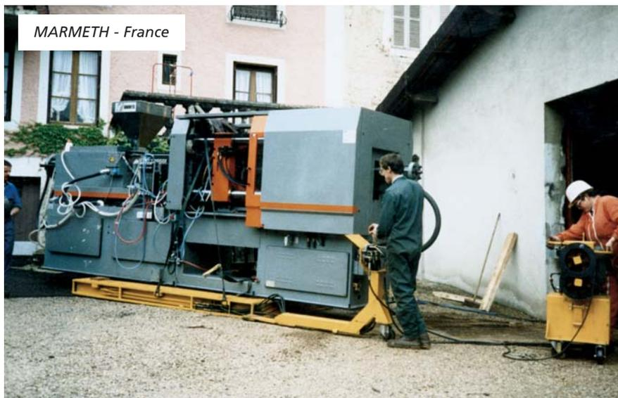
Le déplacement au pas à pas permet à la TORTUE de se mouvoir sur tous types de sol et ce à pleine charge (de 50 à 200 tonnes selon modèle).
