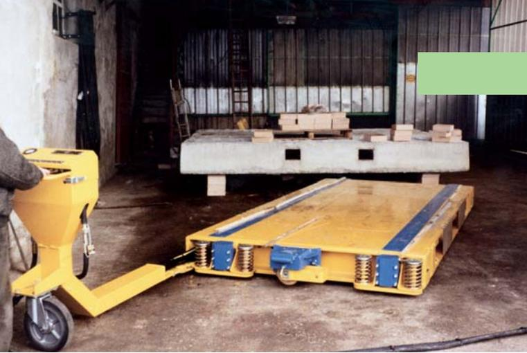
Chaque TORTUE dispose d'une fonction de rotation hydraulique.
