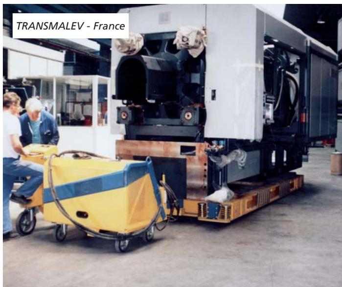
La TORTUE est munie de roues escamotables permettant de rouler RAPIDEMENT sur sol dur et plan.
