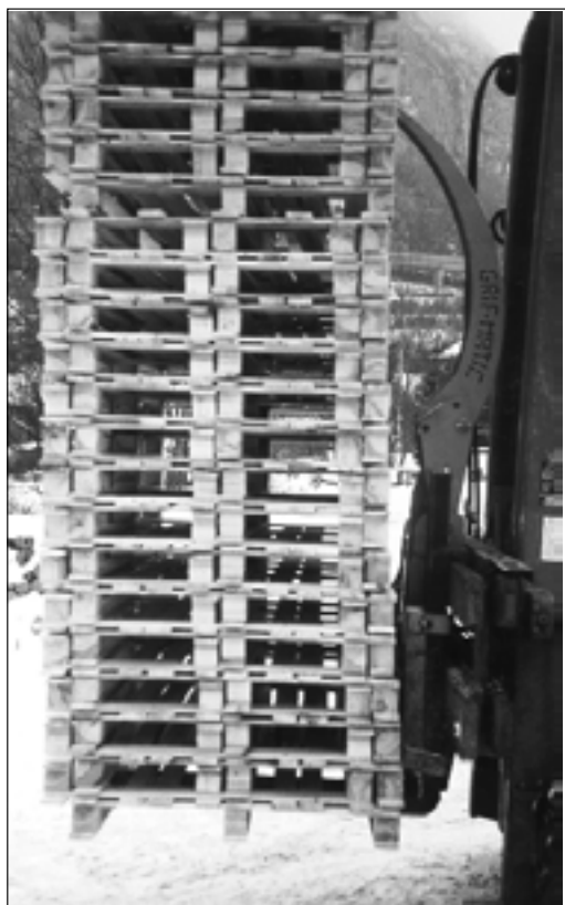
L'escamotage intégral de la Grif-Matic, permet la prise de charges habituelles sans limite de hauteur
