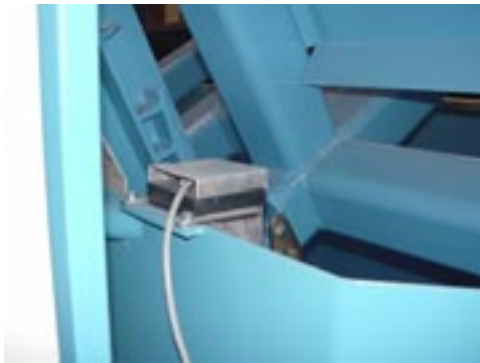
Des capteurs inox contrôlent le niveau du bain
