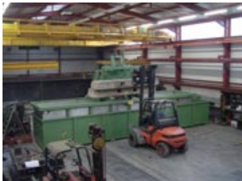
Test de bac en charge avant expédition
