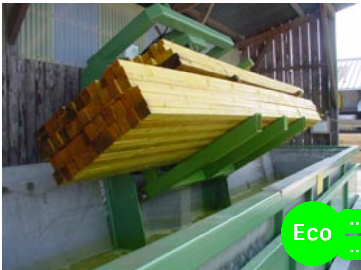
Après immersion, la charge s'arrête en position d'égouttage (31°).
