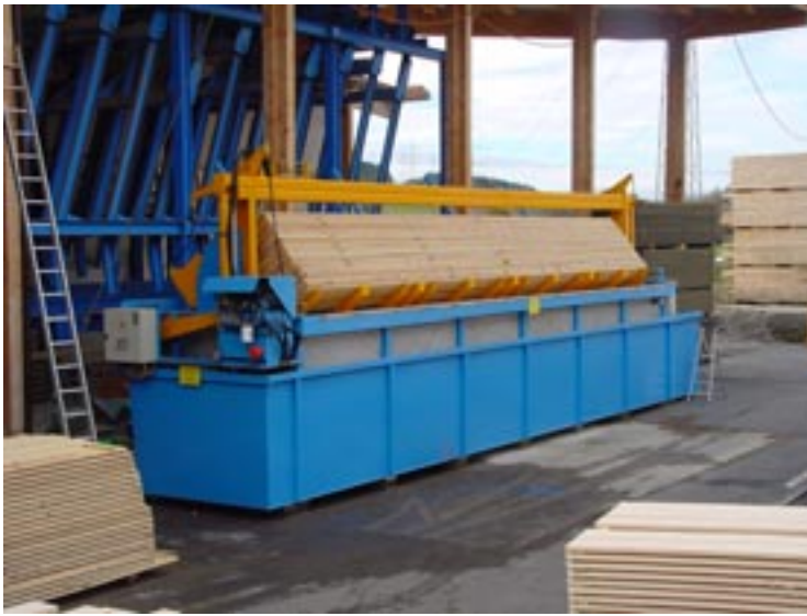
Les vérins de trempage demeurent verticaux lors de l'égouttage.
