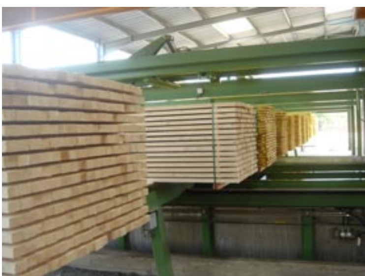
La charge sortant de traitement est évacuée vers le poste d'égouttage et simultanément une nouvelle charge avance sur le bac.
