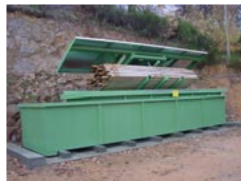
Couvercle incliné durant l'égouttage
