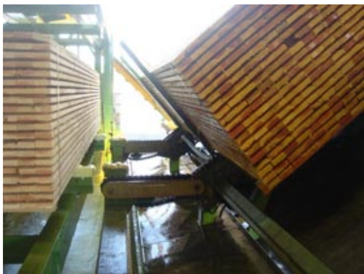
45° d'égouttage latéral permettent un égouttage rapide et complet. Les égouttures sont collectées pour retourner vers le bain.
