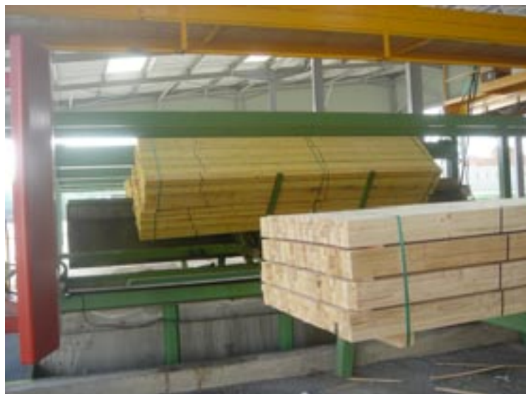
Une charge en attente, une en immersion, une en égouttage
