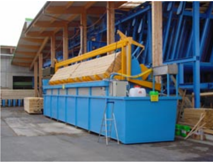
Les charges pivotent autour de leur axe sans déport vers l'arrière
