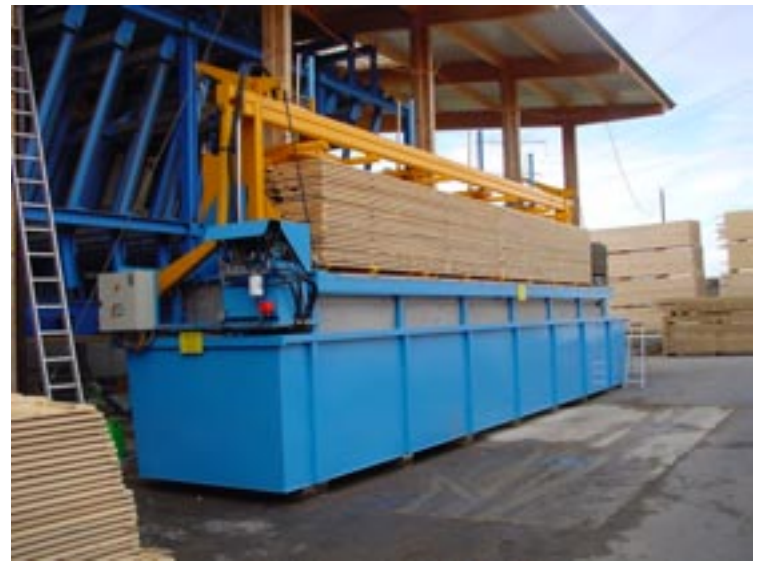
Après égouttage, le châssis remonte à l'horizontal.
