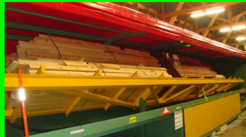
Egouttage diagonal sur 2 axes (40° vers l'arrière ET 1,5° dans la longueur).
