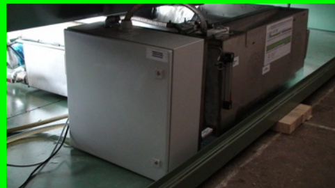
Doseur automatique à niveau constant «IDoseur».
