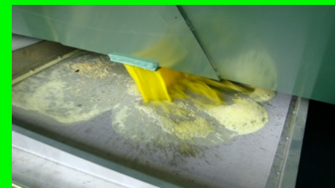
Filtration en ligne des déchets sur grille inox.
