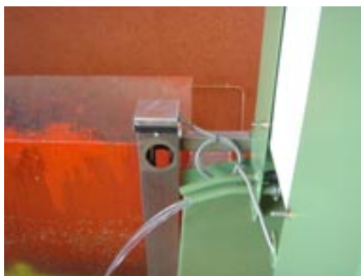
Sondes inox de réglage de niveau
