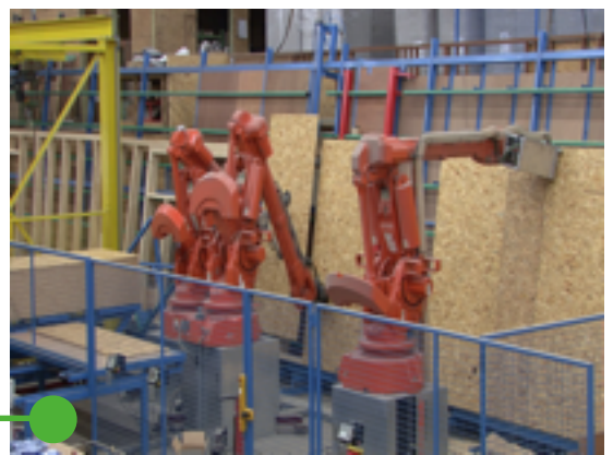
Ligne de production de murs
