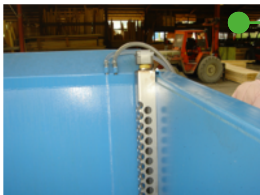
Chauffage hors gel avec thermostat
