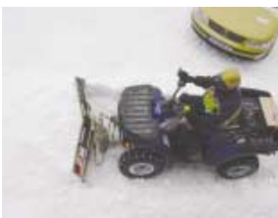
Déneigement professionnel avec une lame VÉ hydraulique sur un quad 4x4.
