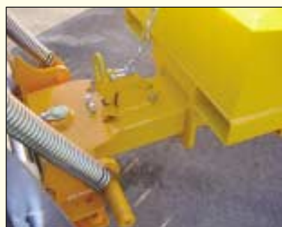
Cônes de centrage et tirants pour fixation du relevage sur la plaque.
