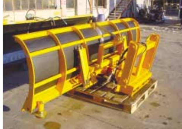
Escamotage par faux châssis.
