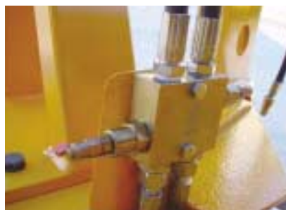
Sécurité hydraulique double.
