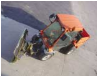
Lame étroite à orientation hydraulique sur engin compact.
