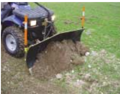
Raclage et remblaiement léger avec une lame en VÉ ne s'enterrant pas de part sa forme triangulaire.
