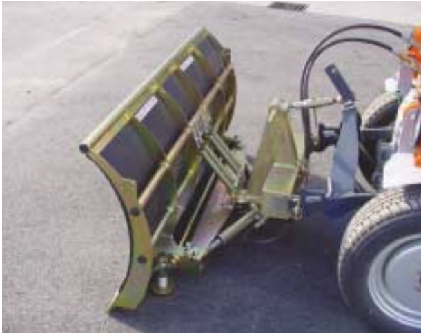
Lame braise sur relevage 3 points avant.
