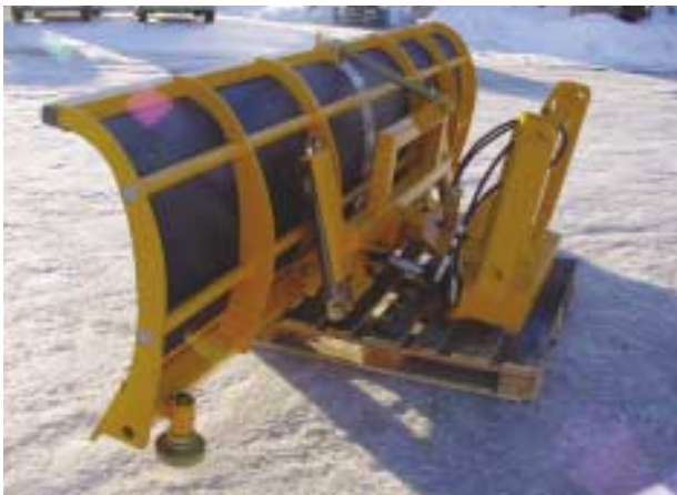
Le sommet de la lame est recourbé pour créer un flux de neige "en rouleau".
