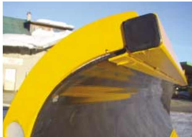
Le sommet de la lame est recourbé pour créer un flux de neige "en rouleau".
