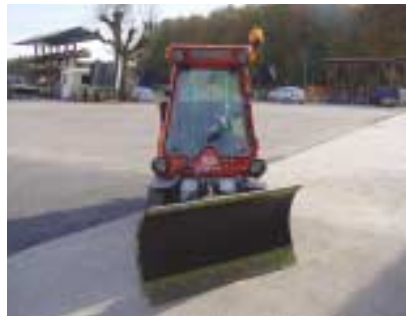
Lame étroite à orientation hydraulique sur engin compact.
