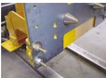
Cônes de centrage et tirants pour fixation du relevage sur la plaque.
