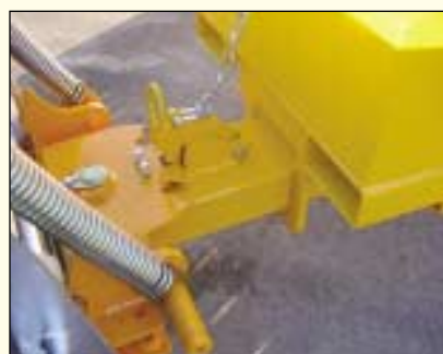
Cônes de centrage et tirants pour fixation du relevage sur la plaque.
