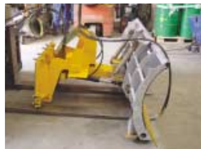
Relevage à parallélogramme pour montage sur plaque SETRA à l'avant.
