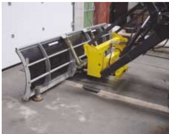
Montage sur relevage 3 points avant.
