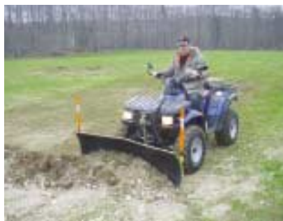
Raclage et remblaiement léger avec une lame en VÉ ne s'enterrant pas de part sa forme triangulaire.
