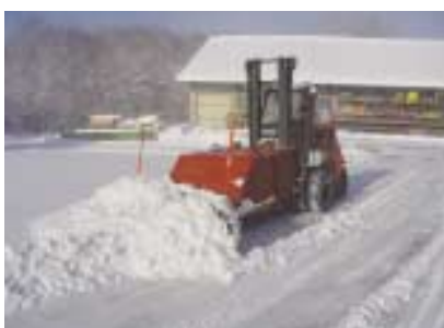
Déneigement des abords et parkings de A2C à 1000 mètres d'altitude dans le massif du Jura avec un chariot élévateur frontal industriel de 4,5 tonnes de capacité à pneus pleins non chaînés.
