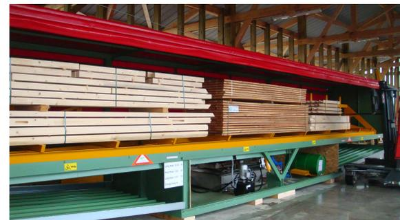
**KESSELDRUCK:** Das Holz wird im herkömmlichen KD-Verfahren imprägniert, dann jedoch geneigt, wodurch ein vollständiges und schnelles Abtropfen oberflächlicher und überschüssiger Lösung erreicht wird.
