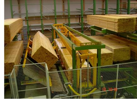
**SPRITZEN:** Das Holz wird besprüht und stark geneigt, wodurch ein vollständiges und schnelles Abtropfen oberflächlicher und überschüssiger Lösung erreicht wird. Die Anlagen benötigen lediglich maximal 1000 Liter an Lösung.
